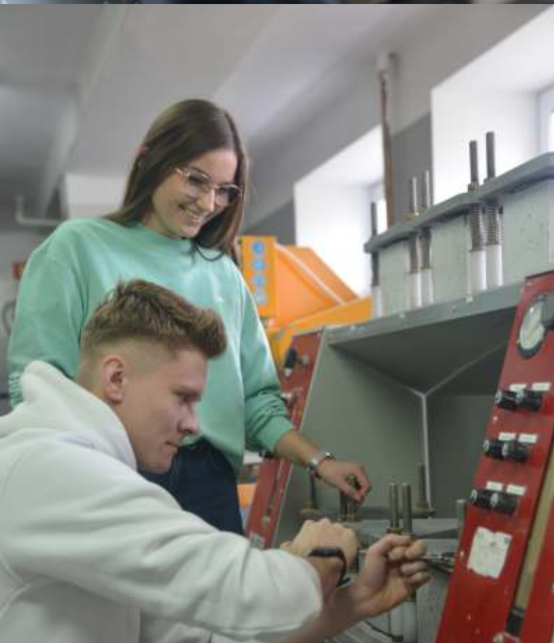
Urządzenie do pomiaru głębokości penetracji wody w betonie
