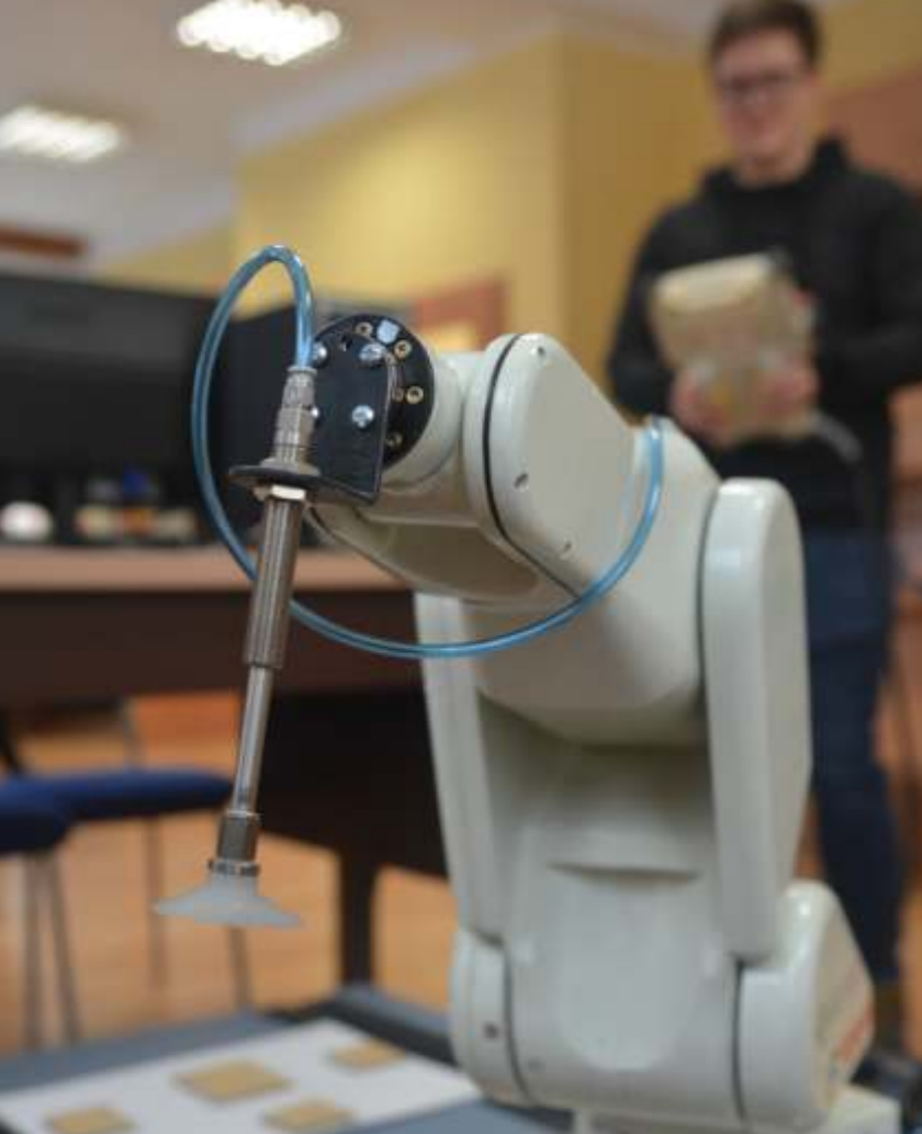
Manipulator elektromechaniczny z chwytakiem pneumatycznym robota przemysłowego Kawasaki – laboratorium robotyki
